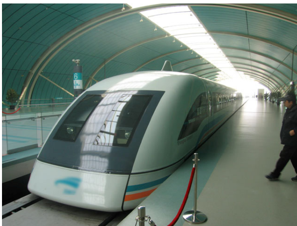
Gambar 2. Kereta Api Cepat Menggunakan Sistem Magnet Terapung
